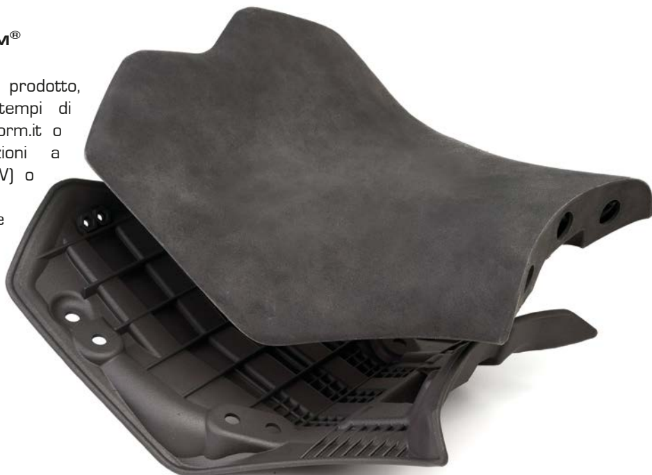
Sella morbida in Windform® RL e sottosella in Windform® GT della moto elettrica Energica realizzate in 3D printing e utilizzate per la produzione pre-serie
